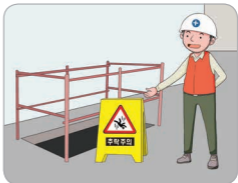
▶ 안전난간 및 경고표지 설치
